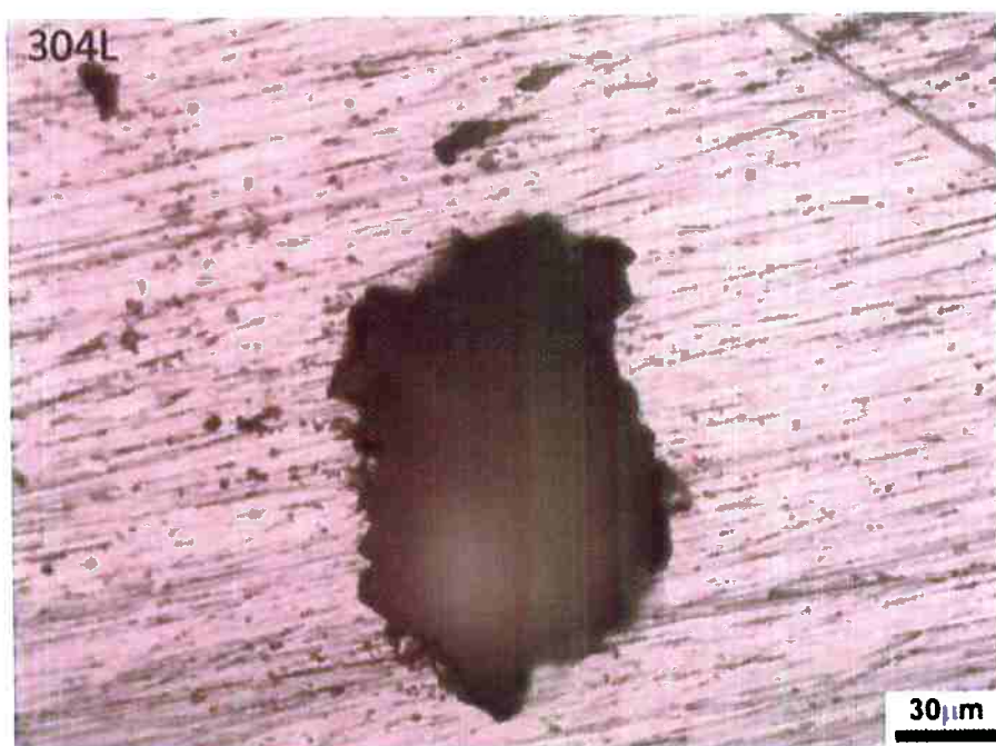
Figura 17 - Morfologia do pite. Ensaio do aço 304L naturalmente aerado.
