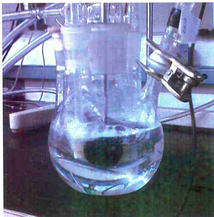
Figura 8 – Célula eletroquímica com uma amostra 304L enquanto era inserido oxigênio.
